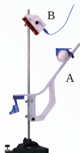
图 5.3-5 用传感器研究平抛运动的装置
