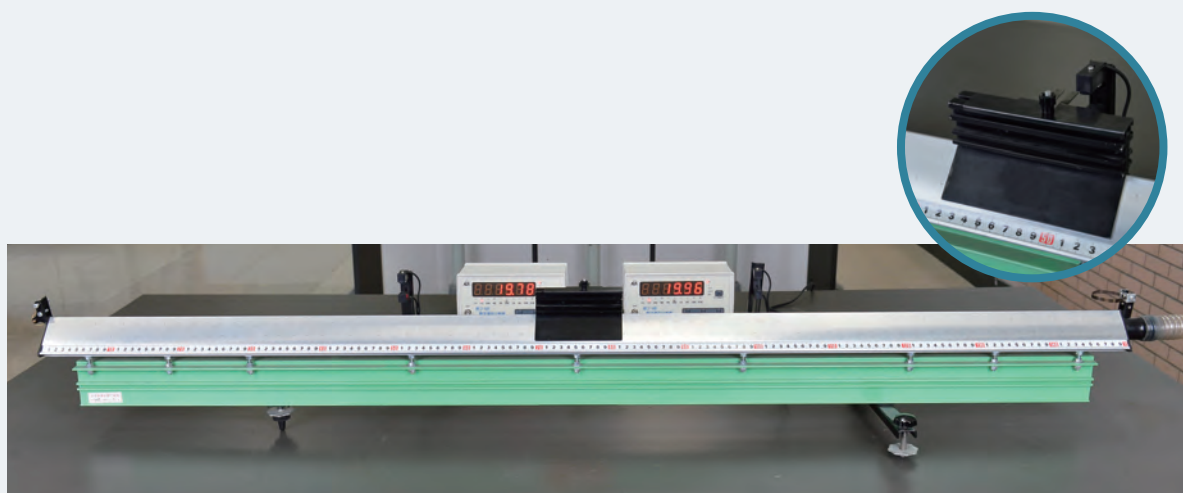
图 8.5-4 研究沿斜面下滑物体的机械能的实验装置
