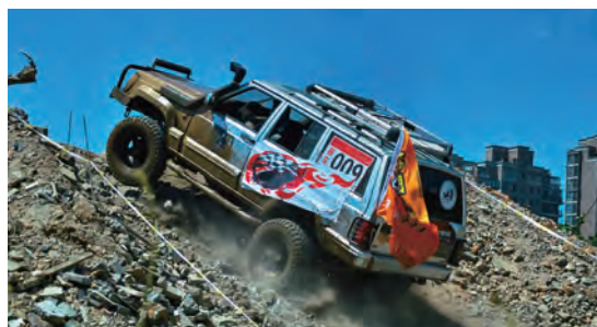
图 8.1-4 汽车上坡时必须使用低速档
