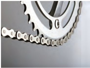
图 6.1-2 自行车的齿轮与链条
