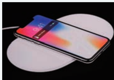
图3.3-4 对移动电话进行无线充电
