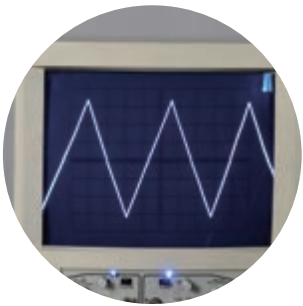
乙 示波器中的锯齿形扫描电压
