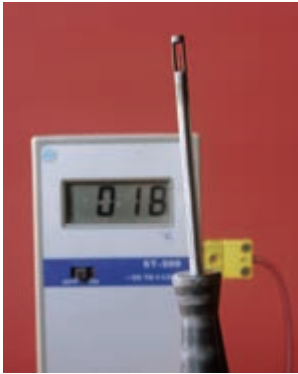
图 5.1-7 热电偶温度计
