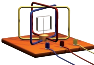
图 2.3-11 产生旋转磁场的装置
