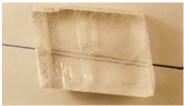
图 2.4-6 方解石的双折射现象
